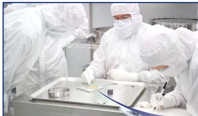
Photographie de l'extraction des fragments pollués du collecteur de vents solaires, au Johnson Space Center de Houston, en salle blanche
