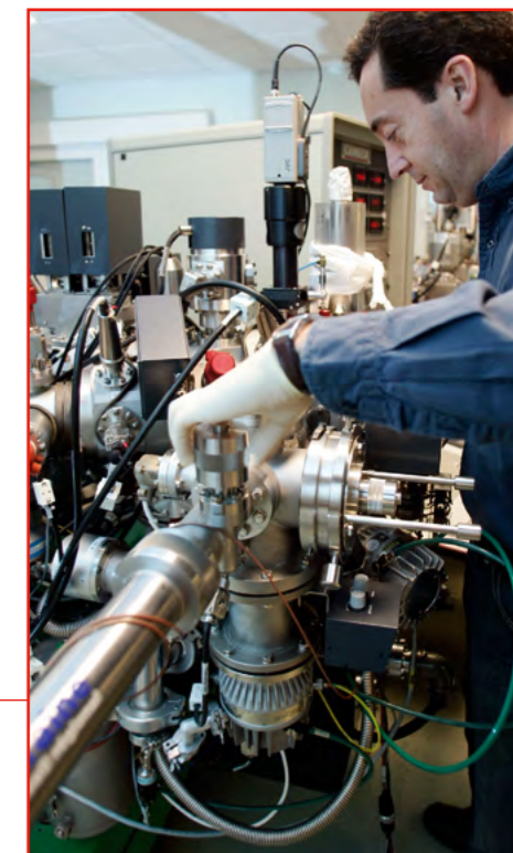
Chargement d'un échantillon de matière extraterrestre dans la sonde ionique
