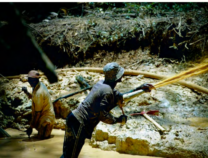
Ils transforment la terre en coulées de boue à la lance molitor
