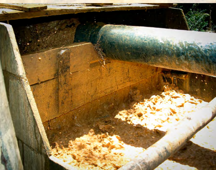
Aspirée, la boue arrive à "la dalle" dans laquelle se trouve un tapis gravimétrique chargé de mercure qui retient les métaux lourds, et donc l'or.
