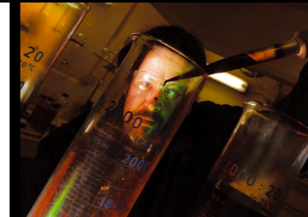
Les échantillons de pétrole brut sont analysés en laboratoire pour évaluer la proportion d'eau / pétrole fournie.
